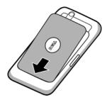
**b** 將蓋板放在裝置背面,並推向裝置頂部方向確保後蓋安裝牢固。
