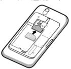
**註**:如不能順利插入卡片,請確認插入時,您將卡上的斜角與卡座上的斜 角對齊。
